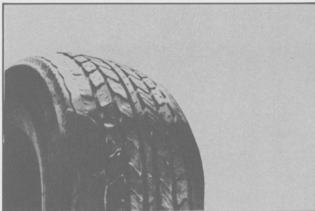
**Fig. 14 Desgaste por incorrecta alineación**
