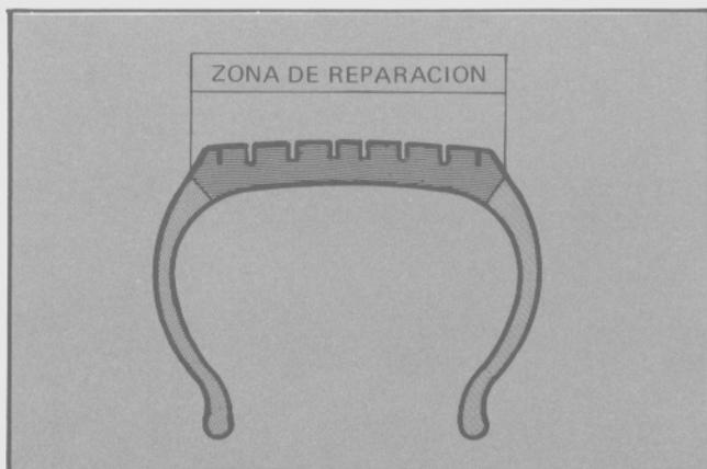
Fig. 20 Zona de reparación del neumático
